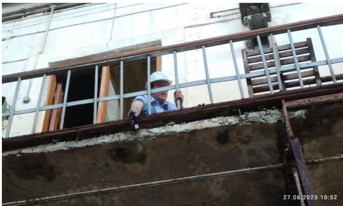
Рис. 88. Измерение прочности монолитной ж/б плиты 2-ого этажа
