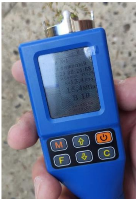
Рис. 25. Измерение прочности отстойки фундамента неразрушающим способом
