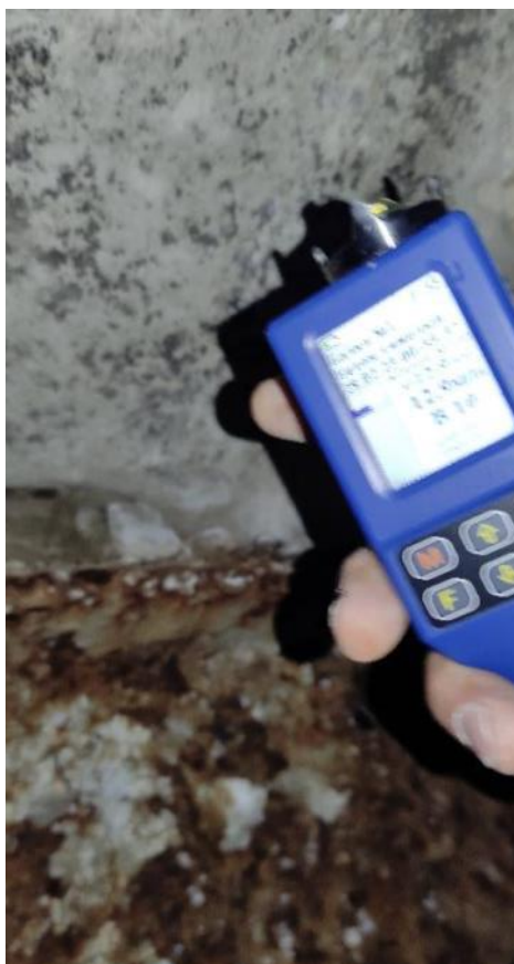
Рис. 87. Измерение прочности плит ПКЖ (класс В12,5-В15)
