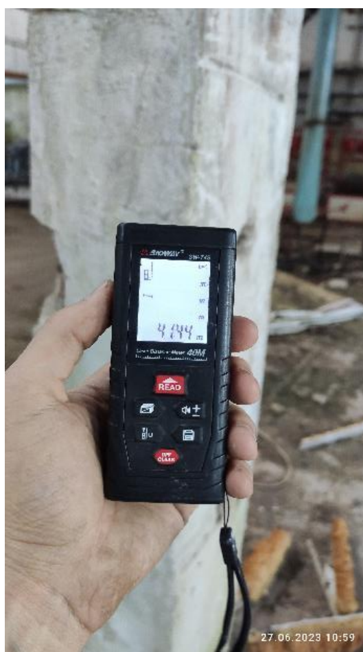
Рис. 53. Измерение высоты колонны (до низа балки)
