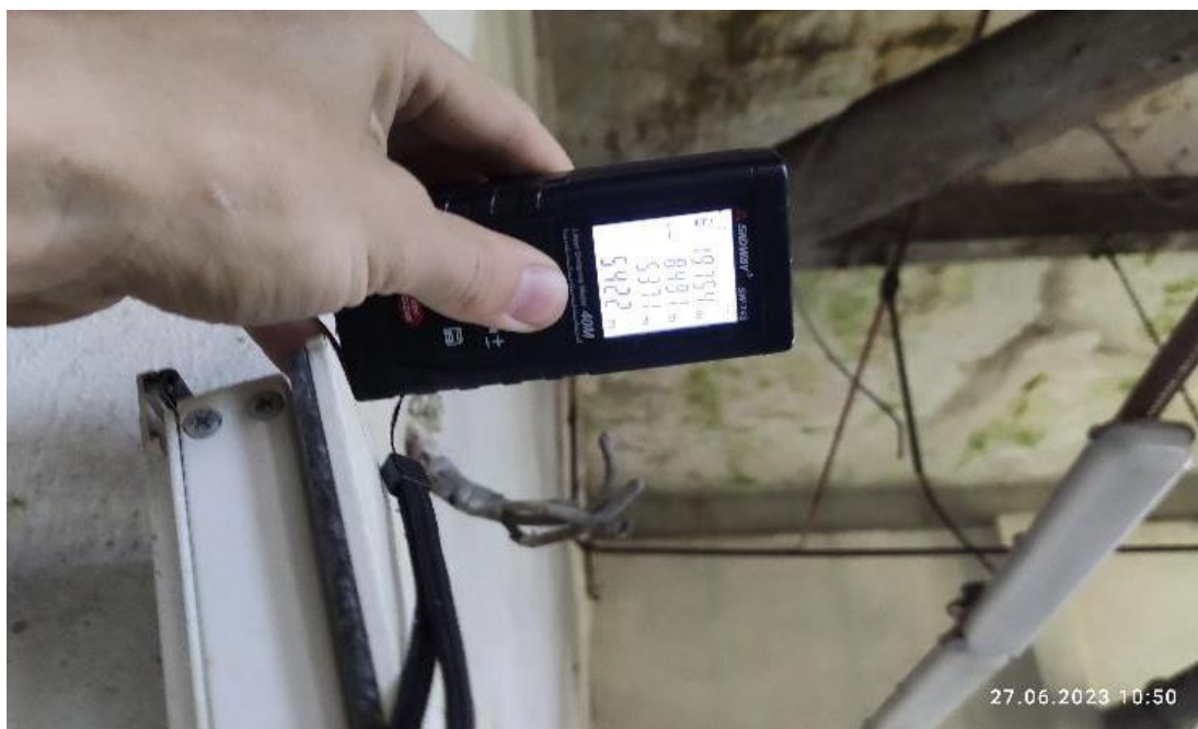
Рис. 52. Измерение расстояния между колоннами вдоль продольной части здания
