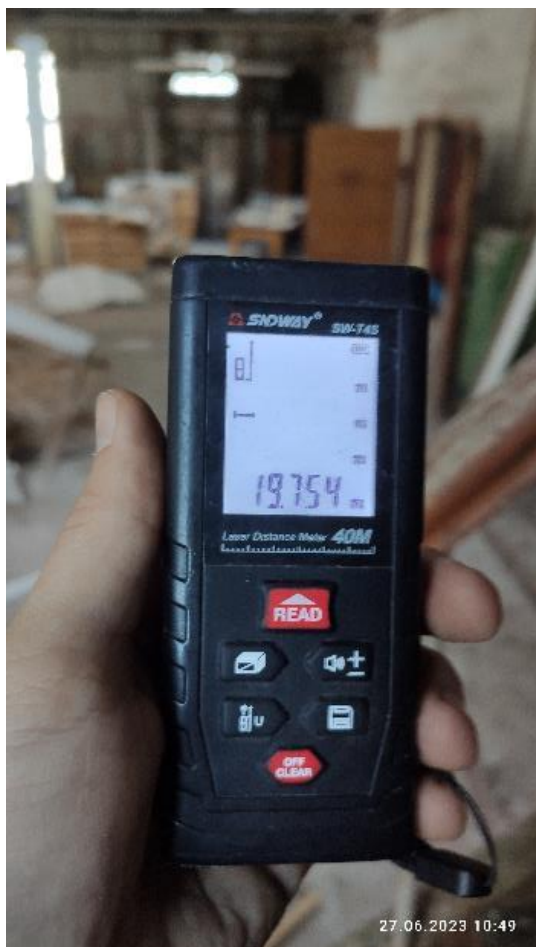
Рис. 49. Измерение пролета здания по внутреннему обмеру
