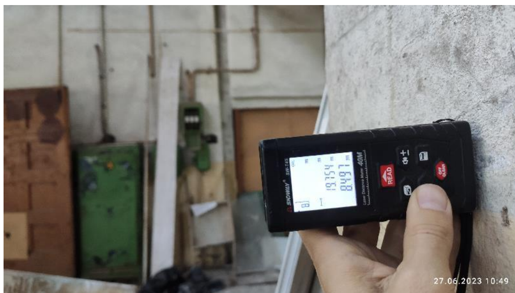
Рис. 51. Измерение расстояния между колоннами в средней части пролета
