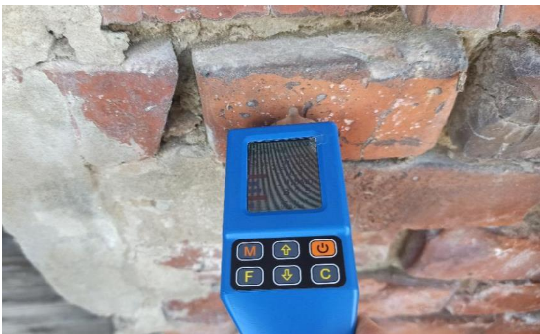
Рис. 64. Измерение прочности кирпича кладки стен (М75)
