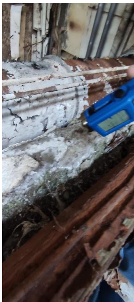
Рис. 89-90. Измерение прочности бетона монолитного перекрытия (класс В7,5-В10)
