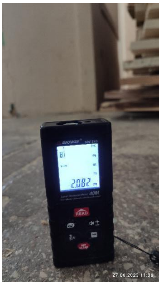
Рис. 58. Измерение высоты в наиболее низкой части цеха деревообработки
