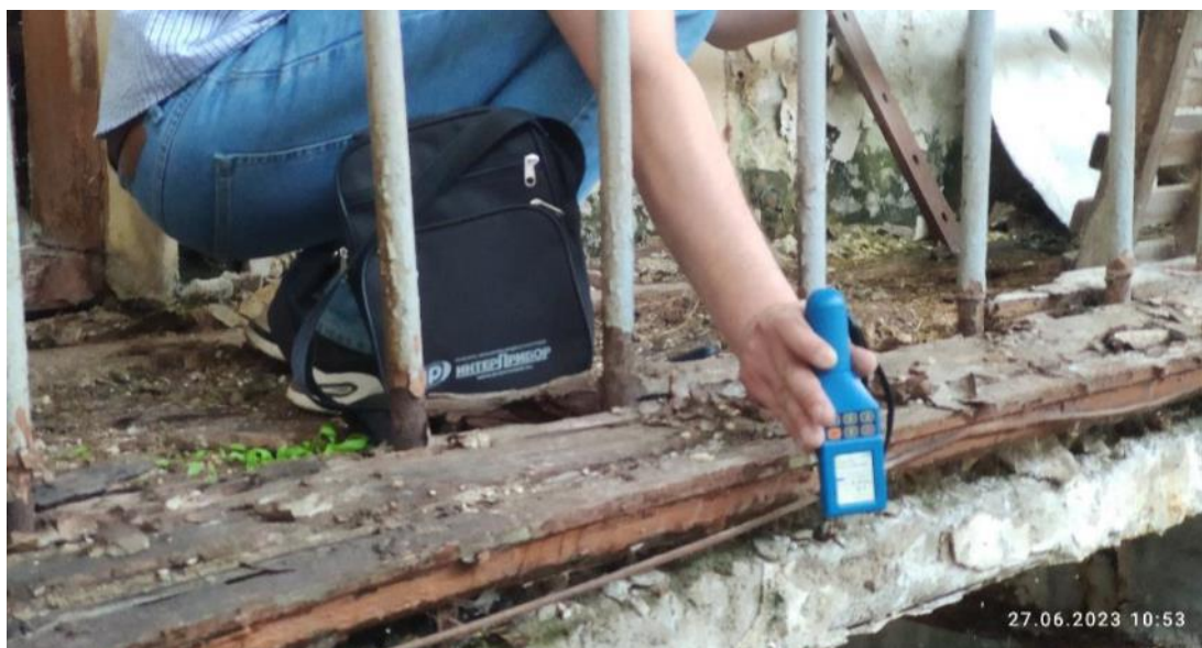
Рис. 91. Измерение прочности монолитной плиты (класс В12,5)
