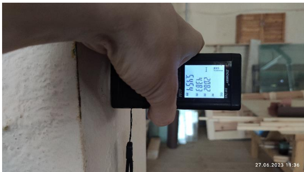
Рис. 60. Измерение шага колонн
