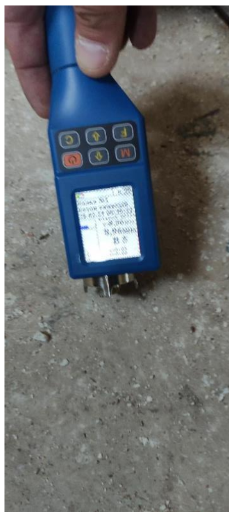
Рис. 118-119. Измерение прочности бетона полов
