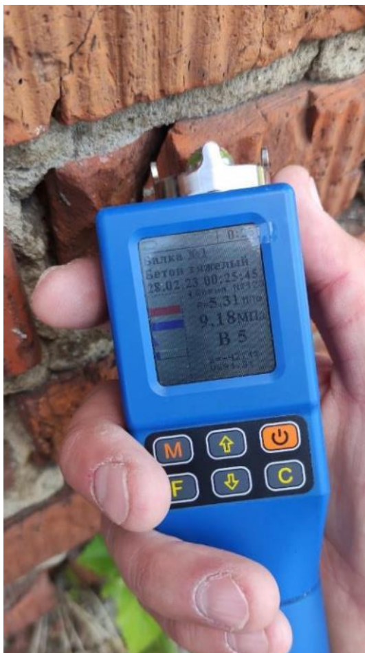
Рис. 63. Измерение прочности кирпича кладки стен (М50)
