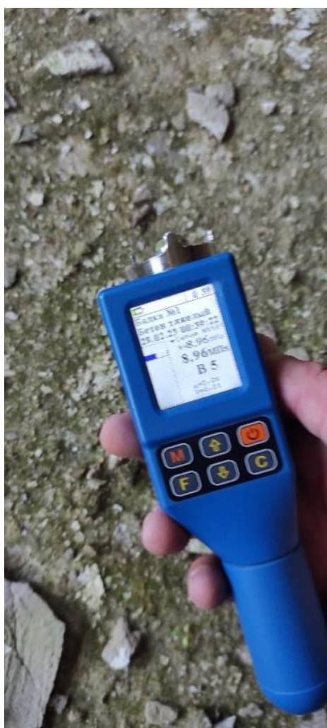
Рис. 118-119. Измерение прочности бетона полов
