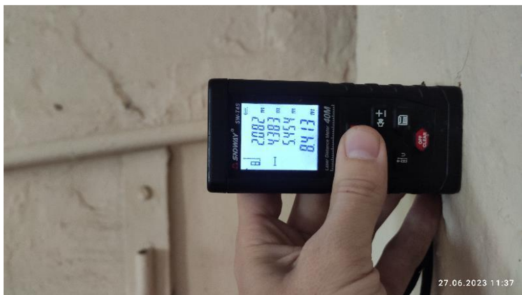
Рис. 61. Измерение расстояния между колоннам в продольном направлении
