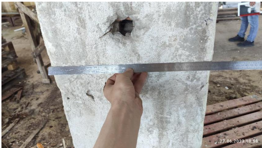
Рис. 57. Измерение ширины сечения колонны
