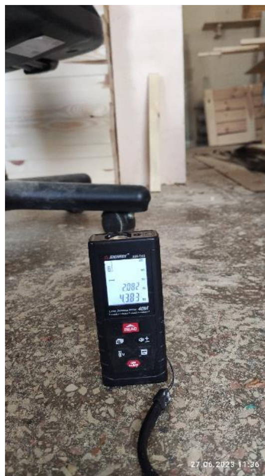
Рис. 59. Измерение высоты наиболее высокой части цеха деревообработки
