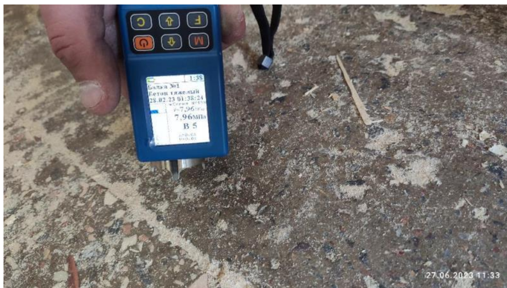
Рис. 117. Измерение прочности бетона полов (класс В5)
