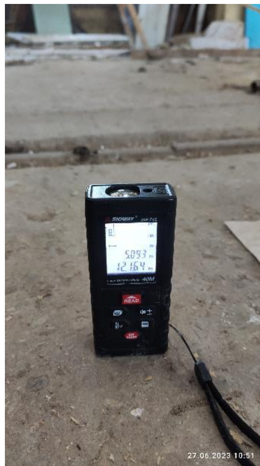
Рис. 50. Измерение высоты от пола до фермы (до плиты покрытия по краям здания и до фонаря)
